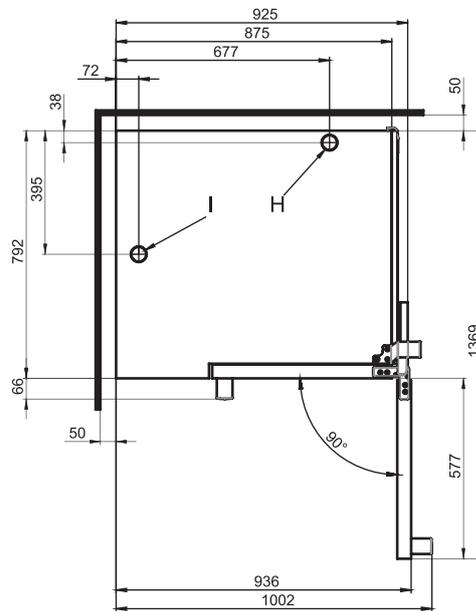
Positions de raccordement au fond de l'appareil
