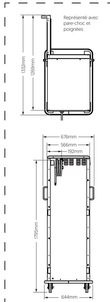
Représenté avec commande simple et roulettes de 89 mm
